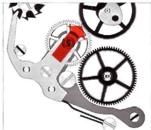
Si tel est le cas, écarter délicatement la bascule d'embrayage afin de provoquer le désengrènement entre la roue d'embrayage et le mobile de chronographe.
