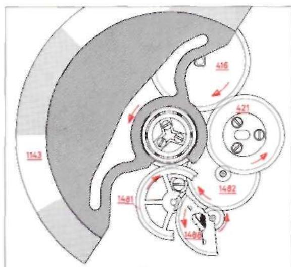
Dans l'autre sens, la masse oscillante (1143) actionne le rochet (416) par l'intermédiaire du mobile de réduction (1481), de la roue-cliquet (1488), du renvoi d'inverseur (1499), du mobile entraîneur de roue de couronne (1482) et de la roue de couronne (421),
