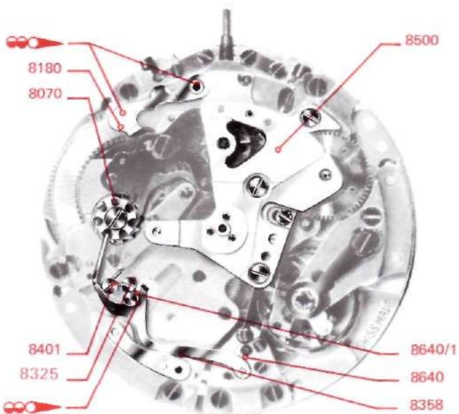
31. Visser: La commande (8140) et graisser sa vis (58140) et son appui sur le pont de barillet (@se»-). Le sautoir de roue à colonnes (8355). Le ressort de commande (8335) et le ressort de marteau (8350).
