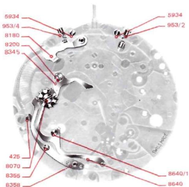
29. Enlever le plot de maintien de l'interrupteur (8640/1) et l'interrupteur (8640).
