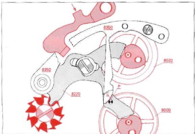
D'autre part, un mécanisme fixé sur le marteau de chronographe permet au moyen d'une vis, de régler facilement la position des pannes du marteau avec les cœurs.
