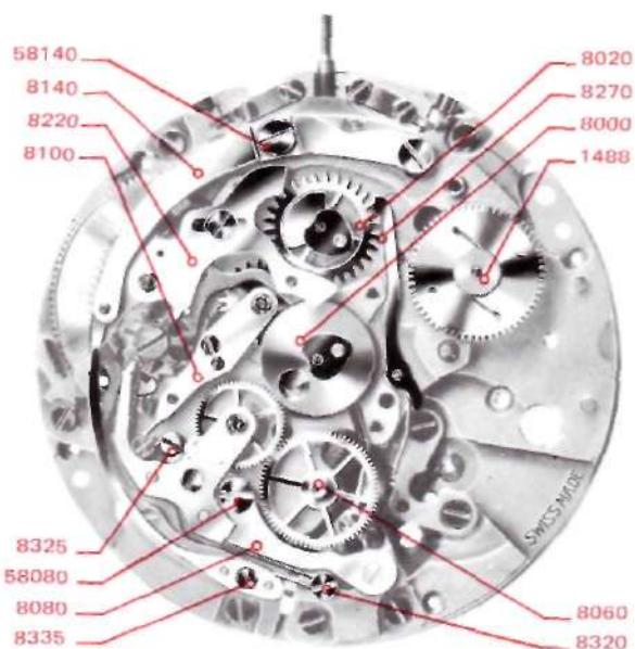
22. Enlever le marteau (8220), le mobile de chronographe (8000), le sautoir du compteur des minutes (8270), le mobile de compteur des minutes (8020), la roue-cliquet (1488) et le baladeur (8100).
