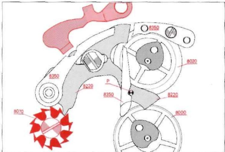
Lors de la remise à zéro, le marteau de chronographe (8220) se libère de l'encoche du ressort (8350). Puis sous l'action de celui-ci, la dernière phase de remise à zéro s'effectue automatiquement par le glissement de la goupille (P) le long de la courbe (C).
